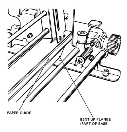
ADJUST FOR 0.10 TO 0.14 INCH GAP BETWEEN PAPER GUIDE AND BENT-UP FLANGE (FLANGE IS PART OF BASE)
