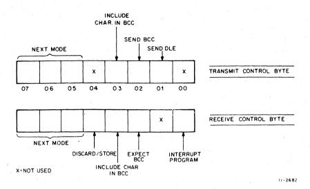
Figure 3-2 Control Byte Formats
