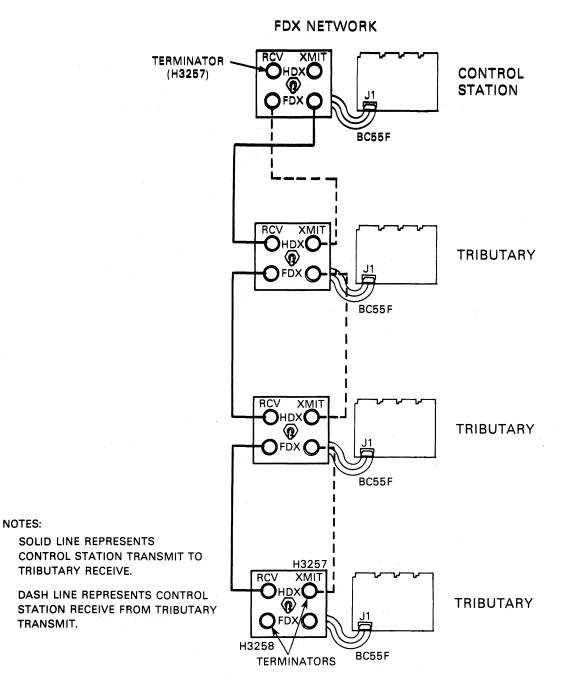
BOTH ENDS OF THE TRANSMIT LINE FROM THE TRIBUTARIES NEED TERMINATION IN ADDITION TO THE ONE TRANSMIT LINE FROM THE CONTROL STATION
