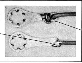
~*REJECT*- INSULATION RUNS INTO SOLDER JOINT.
