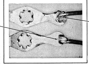
*REJECT*-COLD SOLDER JOINT, POUROUS JOINT.
