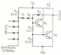
1K PULL-UP RESISTOR FOR AOS DUAL GATE LINE DRIVER
