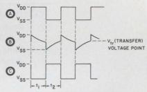
FIG.2. VOLTAGE WAVEFORM FOR ASTABLE MULTIVIBRATOR
