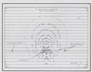
COMPUTER PLOT OF EQUAL-POTENTIAL SURFACES (RF MAGNETIC FIELD) AROUND MICROSTRIP LINE WITH  $\mathbf{\mathcal{E}}=9$
