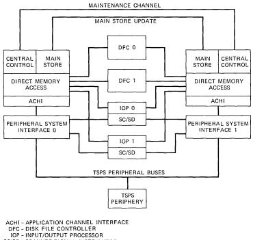
SC/SD - SCANNER/SIGNAL DISTRIBUTOR TSPS - TRAFFIC SERVICE POSITION SYSTEM
