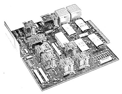
Fig. 28—CCIS plug-in trunk.
