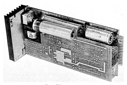
Fig. 4—Voltage converter.
