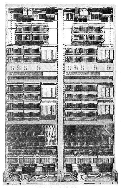
Fig. 8—4A terminal basic frame.
