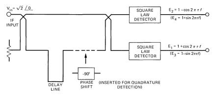
Fig. 11—Delay-line detector.
