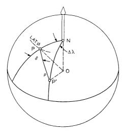
Fig. 4-Geometry determining the latitude and longitude shift.
