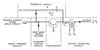
Fig. 5 - RC feedback amplifier.
