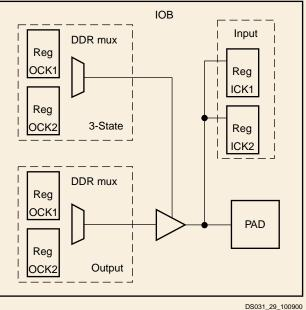
Figure 2: Virtex-II IOB Block
