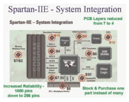
FIGURE 2-7: SPARTAN-IIE SYSTEM INTEGRATION
