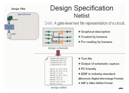
FIGURE 1-8: DESIGN SPECIFICATION - NETLIST
