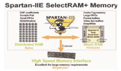
FIGURE 2-13: SPARTAN-IIE ON-CHIP MEMORY
