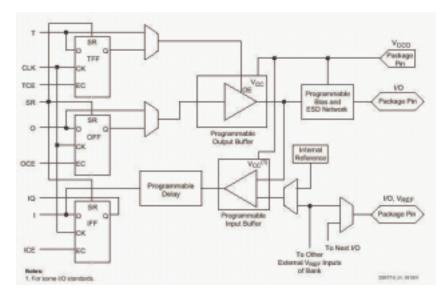
FIGURE 2-10: SPARTAN-IIE INPUT/OUTPUT BLOCK
