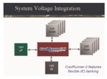
FIGURE 2-38: SYSTEM VOLTAFE INTEGRATION EXAMPLE
