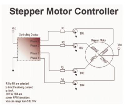
FIGURE 7-1: STEPPER MOTOR CONTROLLER
