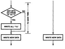
a) PRECONDITIONED DATA BEFORE WRITE b) RANDOM DATA BEFORE WRITE
