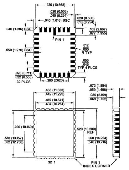
32-PAD CERAMIC LEADLESS CHIP CARRIER PACKAGE TYPE E
