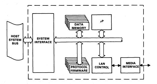
FIGURE 1-8. LAN CONTROLLER-BASED ADAPTER CARD ARCHITECTURE
