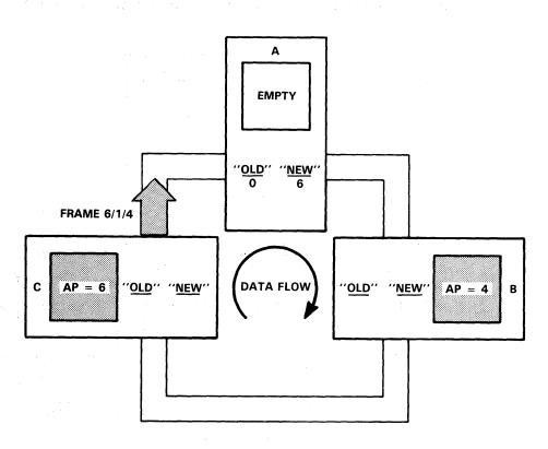
FIGURE 3-28. STATION C CAPTURES TOKEN AND BEGINS TRANSMISSION OF FRAME
