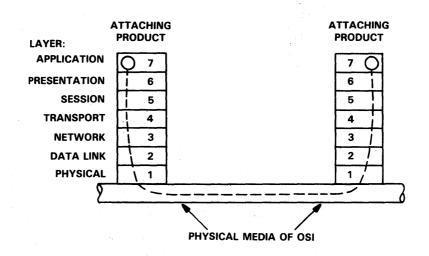
FIGURE 1-2. THE OSI REFERENCE MODEL
