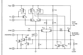
Figure 9. SG1525A/1527A Softstart Circuit
