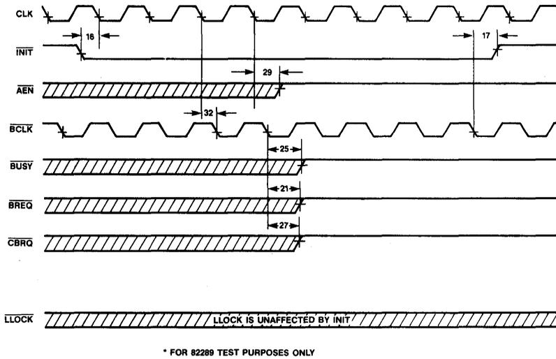
Figure 24. Programming the Always-Release/Common-Bus-Request-Release Option
