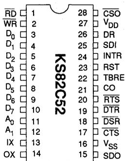
Figure 2 b: 28-PIN DIP CONFIGURATION
