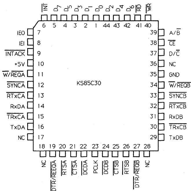
Figure 2a: 44-PIN PLCC CONFIGURATION
