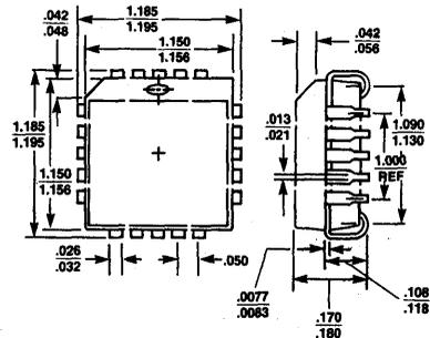
Figure 18. 84-Pin PLCC Package
