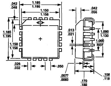
Figure 18. 84-Pin PLCC Package
