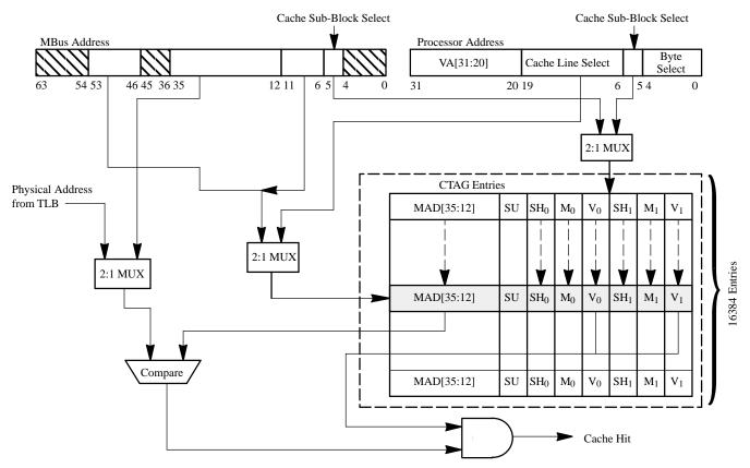
Figure 12. RT626 Cache TAG (CTAG) Comparison (1-Mbyte Cache)
