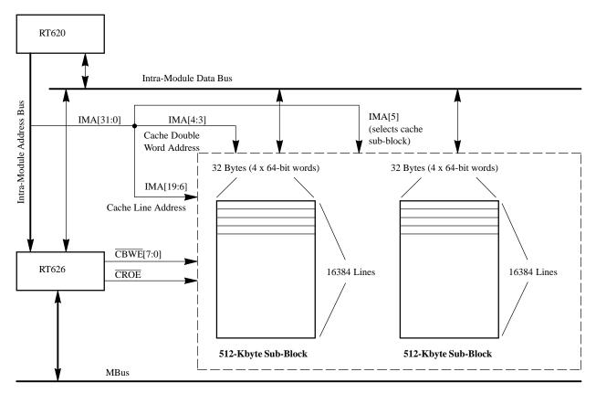
Figure 10. 1-Mbyte Cache Memory Subsystem
