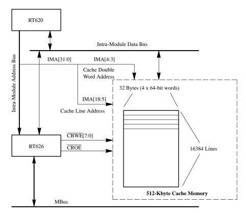
Figure 9. 512-KByte Cache Memory Subsystem
