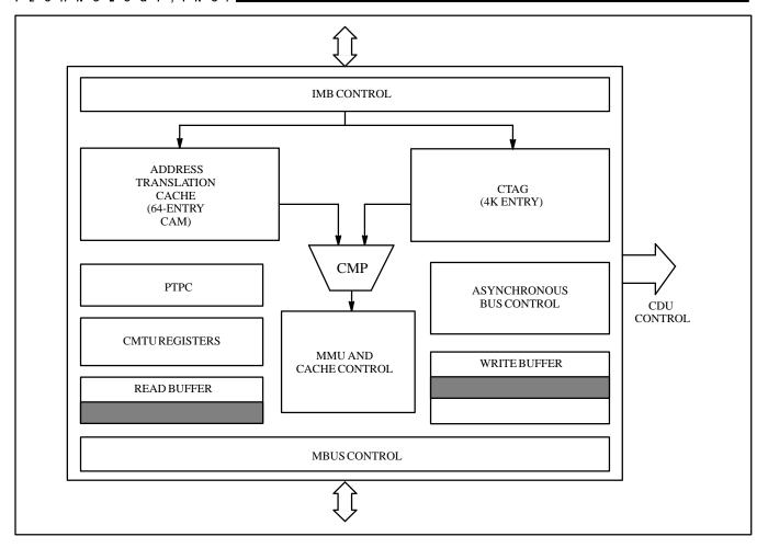
Figure 3. CMTU Block Diagram (RT625)
