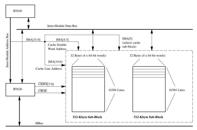
Figure 10. 1-Mbyte Cache Memory Subsystem
