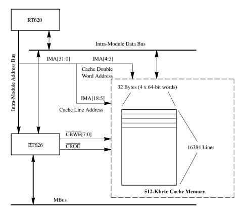
Figure 9. 512-KByte Cache Memory Subsystem
