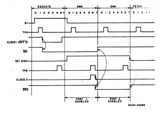
Fig. 3—Timing diagram for the circuit of Fig. 2.
