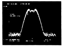
(d) Modulated 1kHz 5kHz deviation 50kHz span
