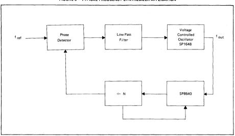
FIGURE 9 - TYPICAL FREQUENCY SYNTHESIZER APPLICATION
