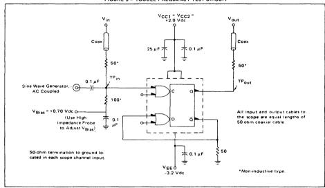
FIGURE 3 - TOGGLE FREQUENCY TEST CIRCUIT
