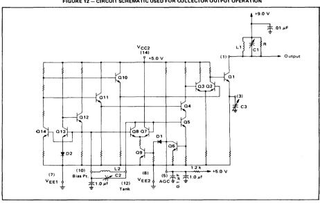
FIGURE 12 - CIRCUIT SCHEMATIC USED FOR COLLECTOR OUTPUT OPERATION
