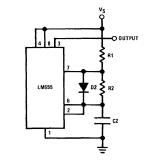
FIGURE 8. Pulse Generator--Astable LM555
