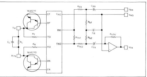
FIGURE 12 - BALANCE NETWORK FOR CAPACITIVE LINES
