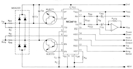
FIGURE 7 - SLIC CIRCUIT
