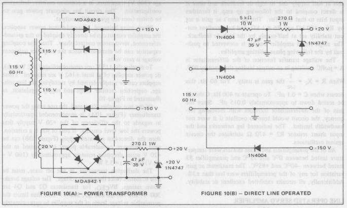
FIGURE 10 - POWER SUPPLIES FOR LINE OPERATED SERVO AMPLIFIER
