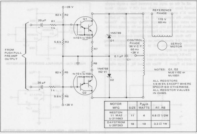
FIGURE 2 - SERVO MOTOR POWER AMPLIFIER
