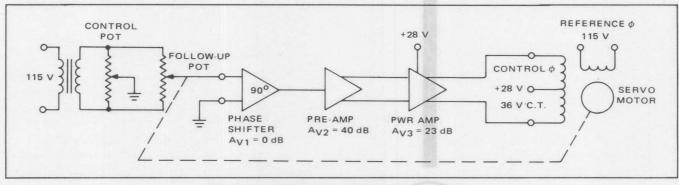
FIGURE 1 - SERVO AMPLIFIER BLOCK DIAGRAM
