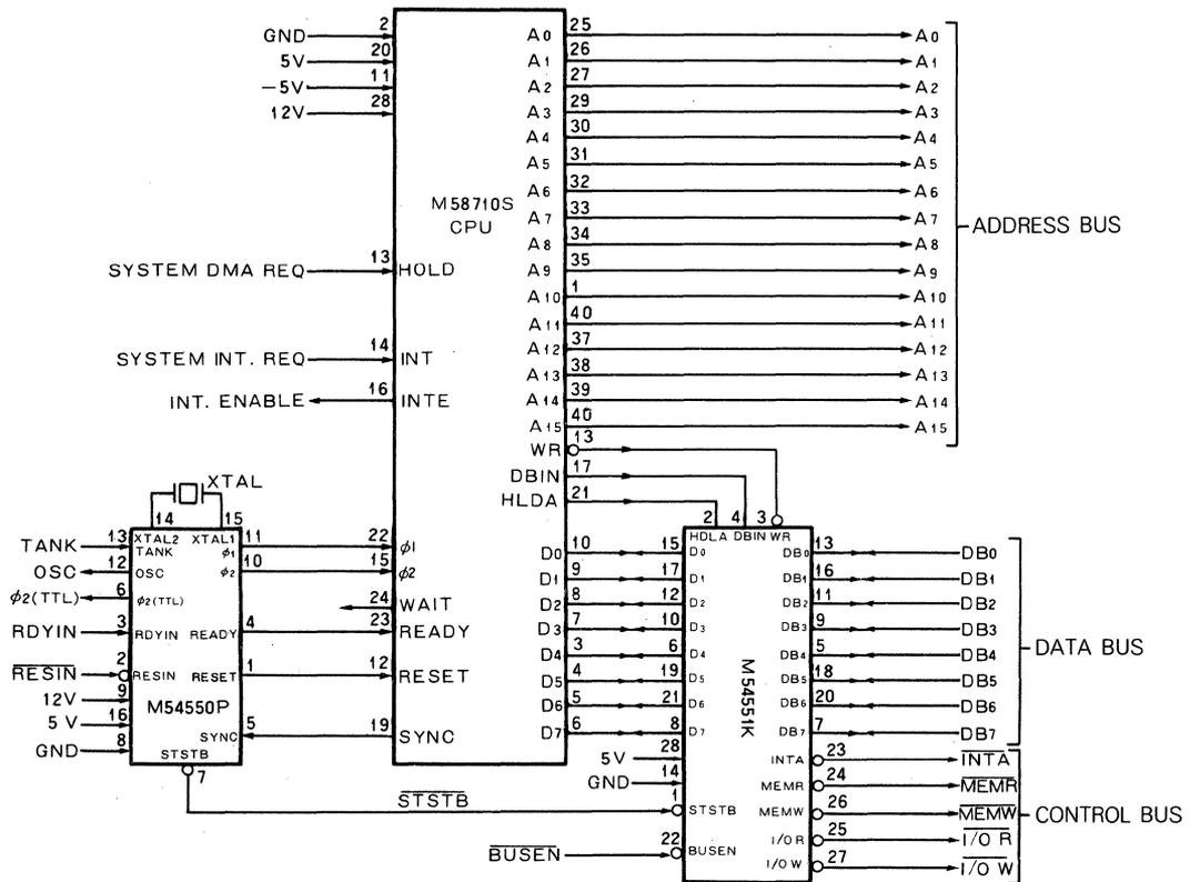
**SYSTEM CONTROLLER AND BUS DRIVER FOR CPU M58710S**
