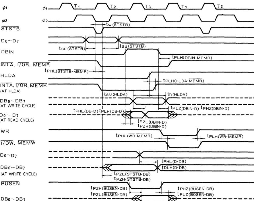
**SYSTEM CONTROLLER AND BUS DRIVER FOR CPU M58710S**
