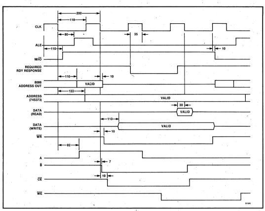
Figure 30. 8086 Min Mode System Timing
