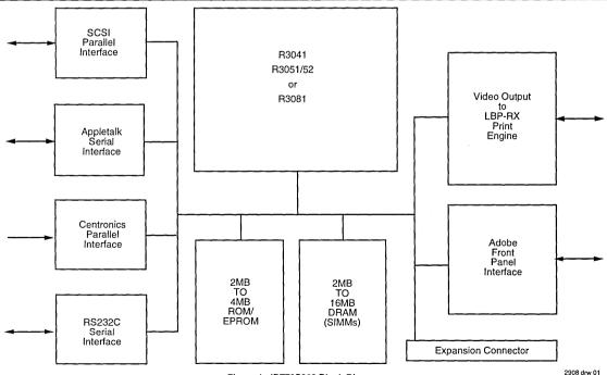
Figure 1. IDT79S389 Block Diagram
