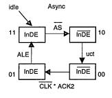
$Q1^{*} = Q1 \cdot Q2 + \overline{Q1} \cdot Q2 \cdot ALE$  $Q2^{*} = \overline{Q1} \cdot Q2 + \overline{Q1} \cdot \overline{Q2} \cdot \overline{CLK} \cdot ACK2$  $+ Q1 \cdot Q2 \cdot ALE$  $InDE = Q2^{A}$
