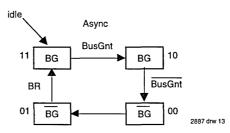
$Q1^{+} = Q1^{+} Q2^{+} Q2^{+} BR$  $Q2^{+} = \overline{Q1}^{+} + Q2^{+} \overline{BusGnt}$  $BG = Q1^{+}$
