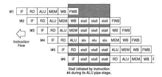
Figure 3.10. An FPA Pipeline Stall
