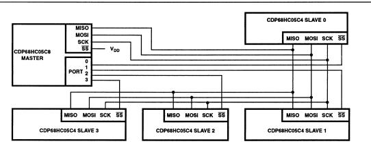
FIGURE 27. MASTER-SLAVE SYSTEM CONFIGURATION (SINGLE MASTER, FOUR SLAVES)
