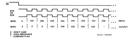
Fig. 4 - Control byte.
