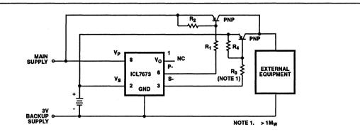
FIGURE 11. HIGH CURRENT BATTERY BACKUP SYSTEM
