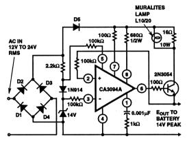
FIGURE 31. BATTERY CHARGER REGULATOR CIRCUIT
