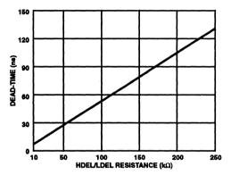
FIGURE 4. MINIMUM DEAD-TIME vs DEL RESISTANCE
