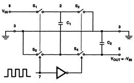
FIGURE 12. IDEALIZED NEGATIVE VOLTAGE CONVERTER
