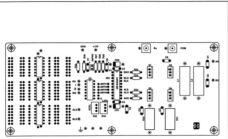
FIGURE 34. HIP4080A EVALUATION BOARD SILKSCREEN
