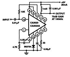
FIGURE 14. 160KHz TUNED AMPLIFIER USING THE CA3020 OR CA3020A
