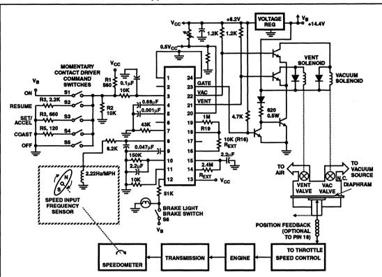
FIGURE 2. A TYPICAL APPLICATION OF THE CA3228E IN AN AUTOMOTIVE CRUISE CONTROL SYSTEM
