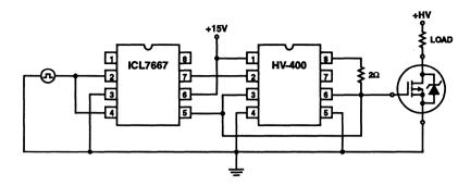
FIGURE 2. LOGIC LEVEL CIRCUIT
