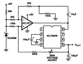
FIGURE 23. REGULATING THE OUTPUT VOLTAGE
