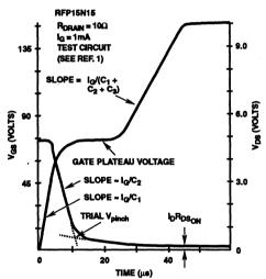
FIGURE 5. DRAIN AND GATE VOLTAGE vs TIME DETERMINE  $C_1,\,C_2,\,C_3$  AND  $V_{\text{PINCH}}$
