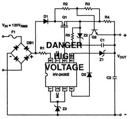
FIGURE 8. OUTPUT VOLTAGE UP TO 35V
