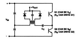
FIGURE 29. HALF-BRIDGE CIRCUIT
