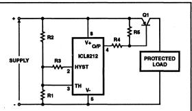
FIGURE 19. LOW VOLTAGE DISCONNECT
