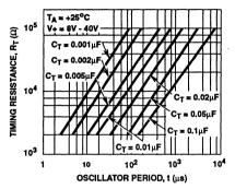
FIGURE 5. TYPICAL OSCILLATOR PERIOD AS A FUNCTION OF  $R_{\rm T}$  AND  $C_{\rm T}$
