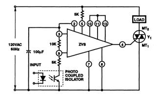
FIGURE 28. ZERO-VOLTAGE SWITCH, ON/OFF CONTROLLER WITH PHOTOCOUPLER
