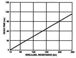
FIGURE 5. MINIMUM DEAD-TIME vs DEL RESISTANCE
