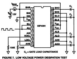
GURE 7. LOW VOLTAGE POWER DISSIPATION TES CIRCUIT
