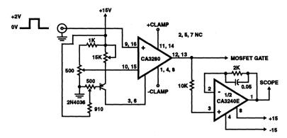
**FIGURE 9. TEST CIRCUIT**
