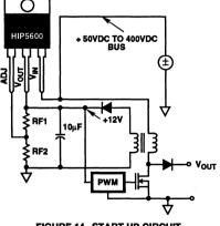
FIGURE 14. START UP CIRCUIT
