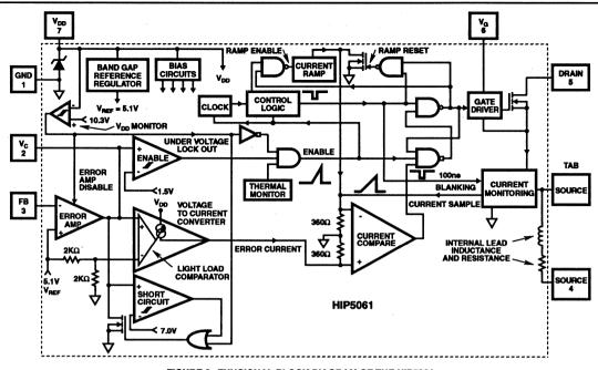
FIGURE 2. FUNCIONAL BLOCK DIAGRAM OF THE HIP5061
