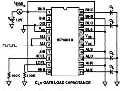
FIGURE 8. LOW VOLTAGE POWER DISSIPATION TEST CIRCUIT
