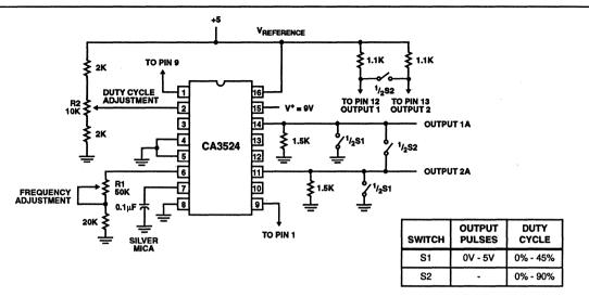
FIGURE 22. LOW-FREQUENCY PULSE GENERATOR
