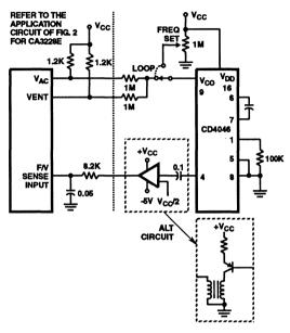
FIGURE 23. PLL OSCILLATOR FREQUENCY CONTROL CIRCUIT
