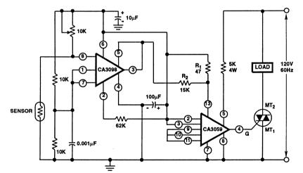
FIGURE 13. SENSITIVE TEMPERATURE CONTROL
