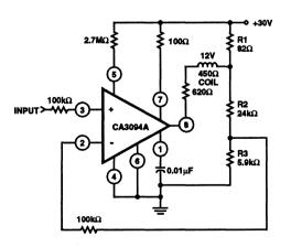
FIGURE 20. PRECISION SCHMITT POWER TRIGGER CIRCUIT
