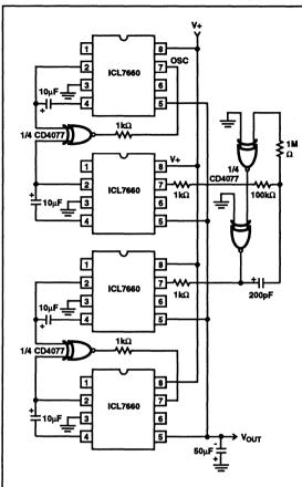
FIGURE 15. SYNCHRONIZING A QUAD
