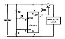
FIGURE 16. HIGH VOLTAGE DUMP CIRCUIT
