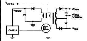
FIGURE 2A. LINE ISOLATED FLYBACK CONVERTER
