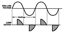
FIGURE 46. WAVEFORMS FOR 60Hz PHASE CONTROLLED LAMP DIMMER
