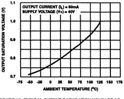
FIGURE 15. TYPICAL OUTPUT SATURATION VOLTAGE AS FUNCTION OF AMBIENT TEMPERATURE
