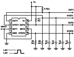
FIGURE 7. TEST CIRCUITS
