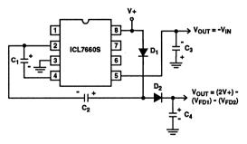
FIGURE 21. COMBINED NEGATIVE VOLTAGE CONVERTER AND POSITIVE DOUBLER
