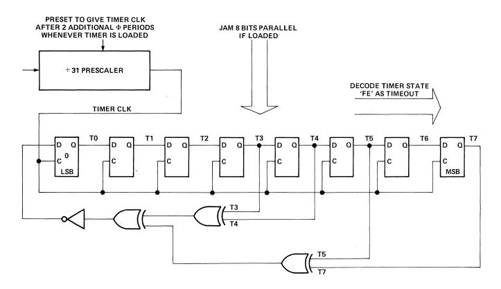
Figure 3-8. Timer Block Diagram
