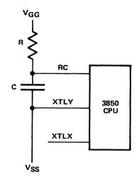
Figure 2-7. RC Mode Clock Generation
