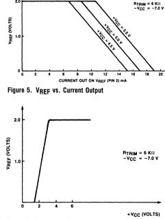
Figure 6.  $V_{REF}$  vs. + V<sub>CC</sub>
