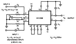
Figure 20. Phase-Detector Circuit
