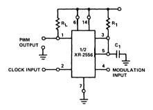
Figure 27. Pulse-Width Modulation
