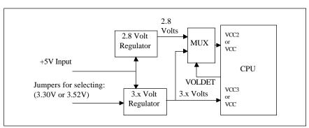
RECOMMENDED POWER SUPPLY BLOCK DIAGRAM
