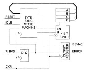
Figure 11. Byte-Sync State Machine Block Diagram
