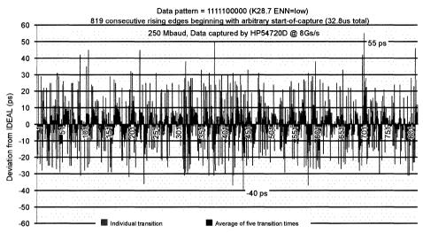
Figure 18. Real-Time HOTLink Transmitter-Output Byte-Rate Jitter
