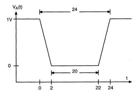
Figure 21.  $V_A(t)$ , Unmodified
