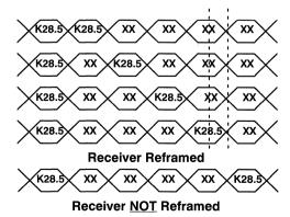
Figure 9. Double-Byte Reframing
