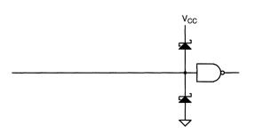
Figure 19. Schottky Diode Termination
