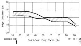
Figure 20. Data Dependent Edge Displacement
