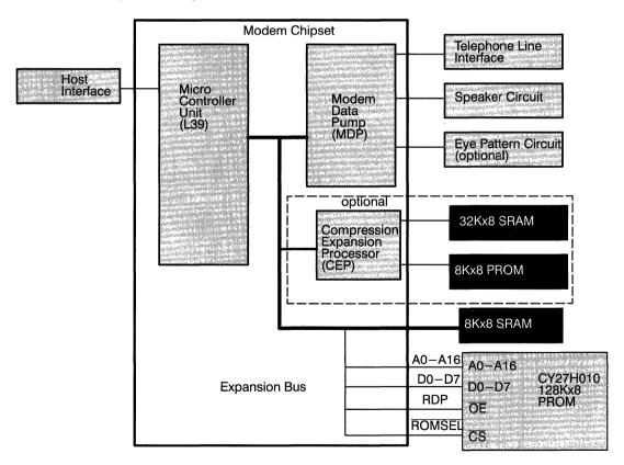
Figure 1. Rockwell V.FAST Modem Block Diagram
